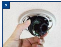
3 Coloque la cámara con el GyroView de 3 ejes
