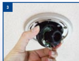
Posizionare la telecamera con GyroView a 3 assi
