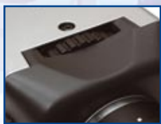
Ghiera di regolazione della profondità di fuoco
